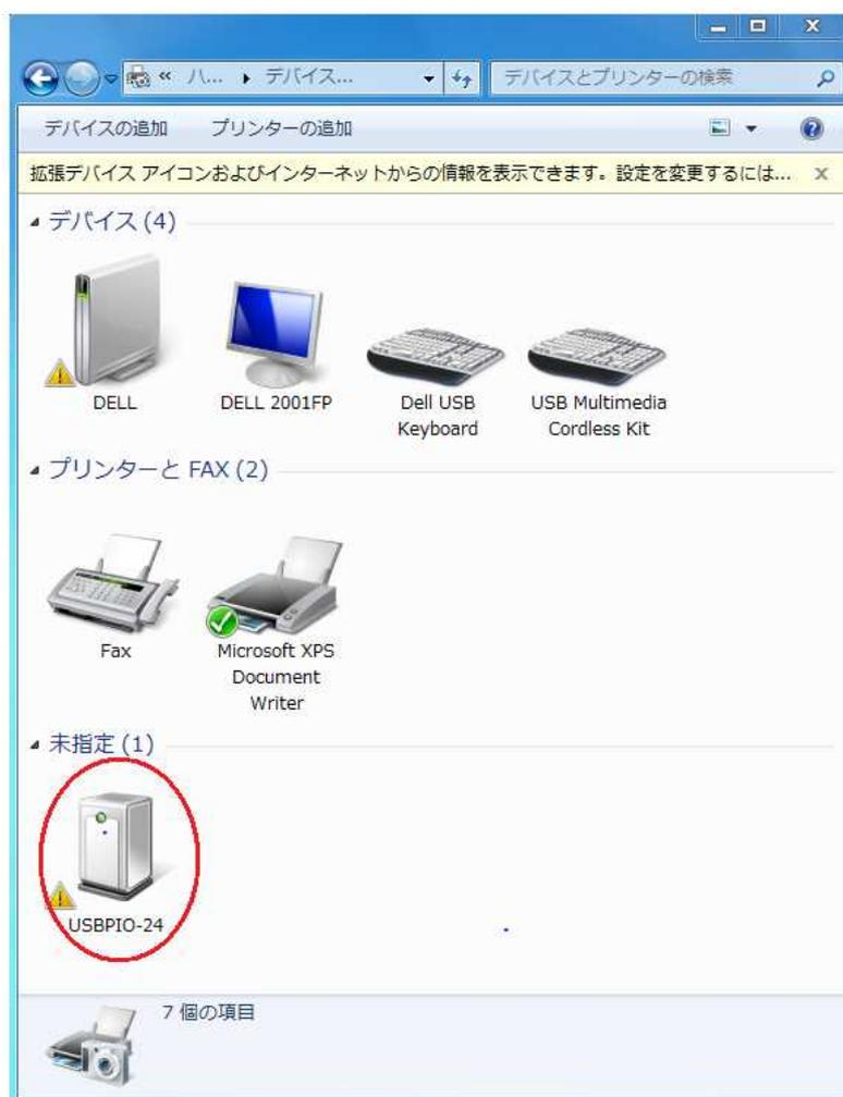
USBPIO-24 のアイコンを右クリックして「ハードウェア」タブの「プロパティ」を開きます。 右下の「プロパティ」ボタンをクリックします。
