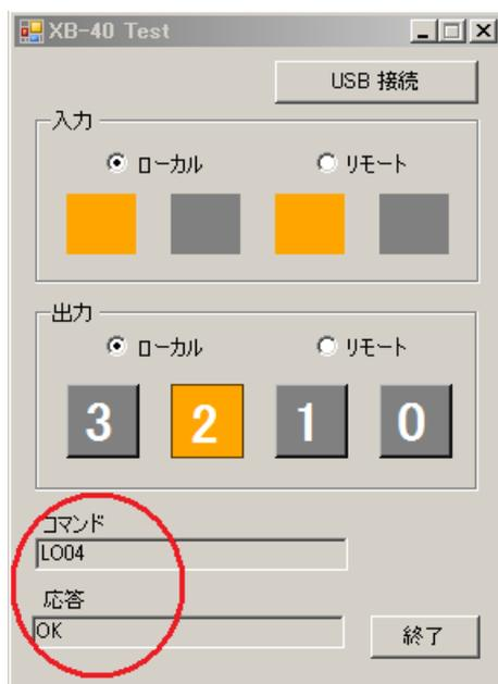
入力グループの[リモート] ラジオボタンをクリックするとリモートボードから無線で送られてきたリモートボード側の接点情報が表示されます。
